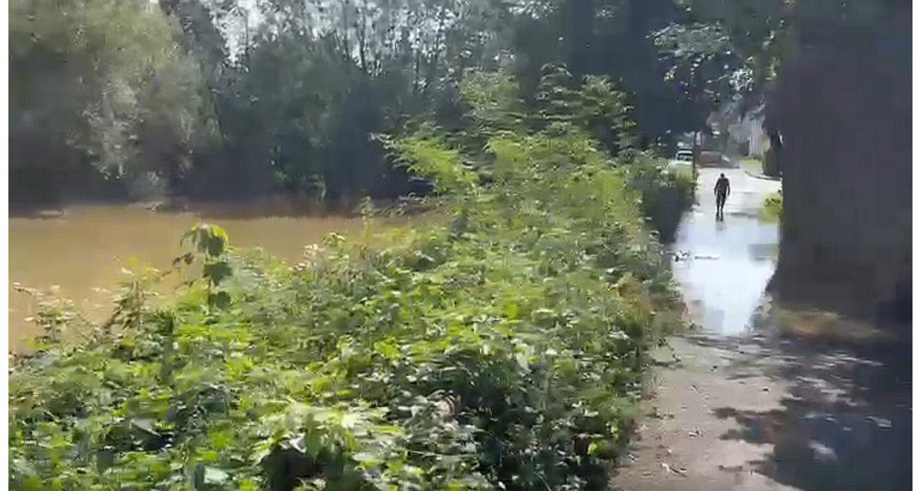
Durch das Aufschütten der Vertiefung im Weg könnte ein barrierefreier Pfad mit einer Steigung von 1-2 % realisiert werden.
